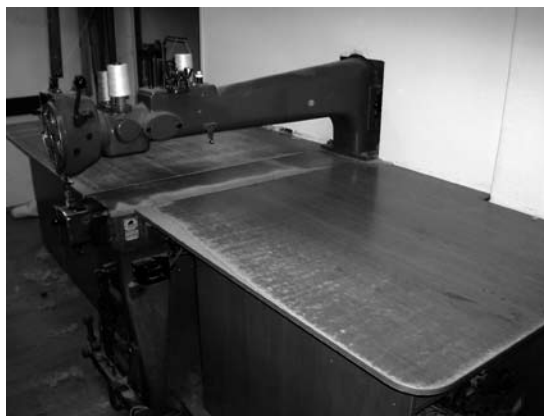
Слика 6. Машина „Mamut“ у јорганџијској радњи „Мрђа“ Fig. 6 Mammut quilting-machine at Mrdja Quilt Shop
