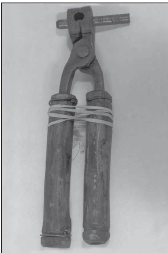
Сл. 8. Калуп за олово Fig. 8 Lead-weight mould
