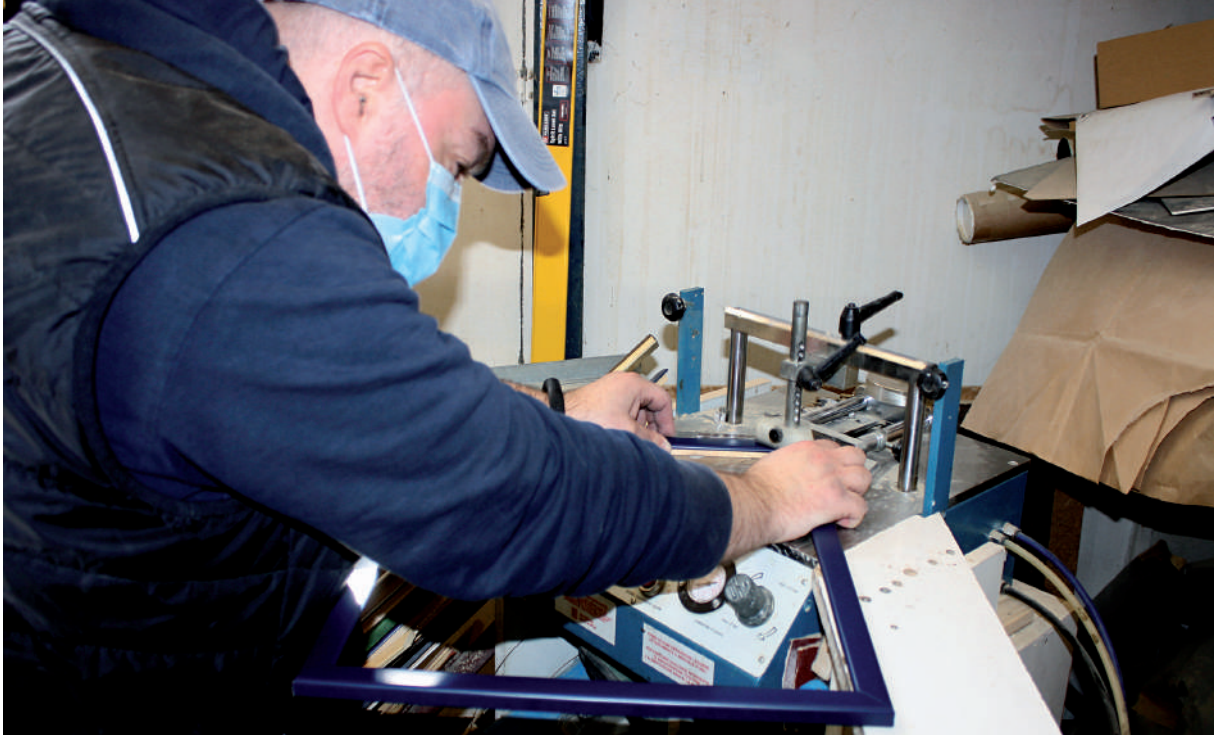
Слика 2. Александар Пантелић у радионици стаклорезачке радње приликом спајања лајсни рамова Figure 2 Aleksandar Pantelić in the glass-cutting workshop joining the frame moldings
